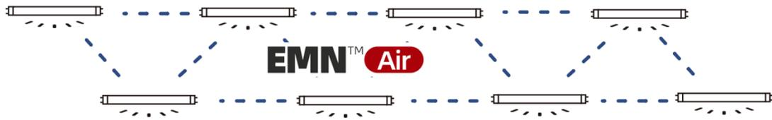
该产品得益于独特的机器学习算法，在完成安装后，便可进入学习状态，通过内置 EMN Self-Tuning 模组进行人车触发信息的持续采集和车辆通行路径的学习，在绑定同路线灯具的同时，可计算车辆平均行进速度并自主决策同路线灯具的亮灯范围与数量，实现“人车未达，预先点亮”、“人车驶离，群体调暗”的动态节能模式。灯群还可针对区域触发热度，主动调整亮灯时长，动态调整节能率平衡，优化照明效果。
